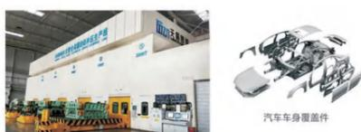
板材柔性成形装备主要包括压力机、自动化上下料系统、自动废料收集系统、一键自动换装置、一键自动更换抓手装置及相关辅助系统等组成。压力机可以匹配液压机（油压机）、机械压力机或复合驱动式压力机；自动化上下料系统可以匹配机架机械手、多轴机器人或三次元自动化系统等。
