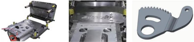
精冲模具是一种精密的冲压加工工艺，它能够在一次冲压行程中获得比传统冲压更高精度的零件。精冲技术的发展始于20世纪60年代的德国，随后在全球范围内得到了广泛应用。精冲技术以其高精度、高效率、高可靠性的特点，在多个行业中有着重要的应用，尤其是在汽车、电子、医疗器械、航空航天等领域。
